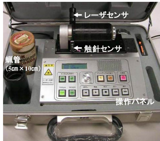
図3 開発した触針とレーザーによる蝋管再生機 (最終版)
