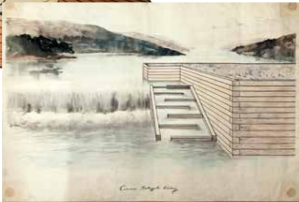
水産学教授用掛図コレクション 「Common Rectangle Fishway」 北大総合博物館蔵
