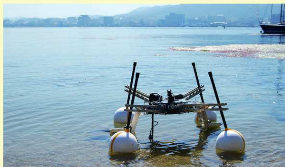
水環境調査用アメンボロボットの琵琶湖における航行試験
